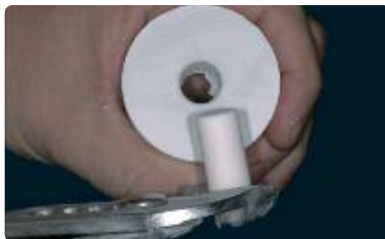
Если стержень извлекать из паковочной массы вращением с помощью щипцов, то он извлекается практически чистым. В любом случае, проверьте, чистый ли он, при необходимости почистите стержень из оксида алюминия частицами Al_2O_3 .
