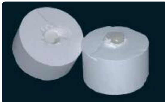
Разделите опоку в соответствии с маркировкой с помощью сепарационного диска
