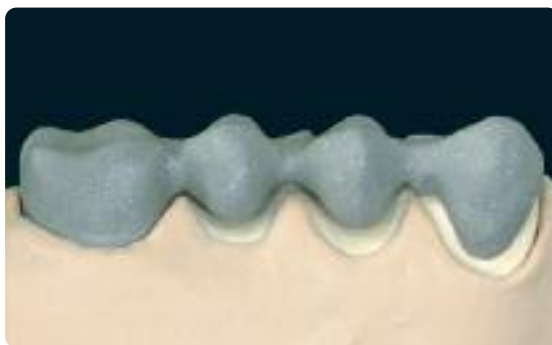
Каркас тщательно отпескоструить оксидом алюминия Al_2O_3 тип 50–100 мкм (см. рекомендации производителя сплава).
