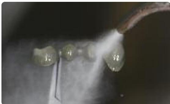
После пескоструйной обработки металлический каркас почистить паром и дать ему высохнуть. Оксидирующий обжиг проводить в соответствии с рекомендациями производителя.
