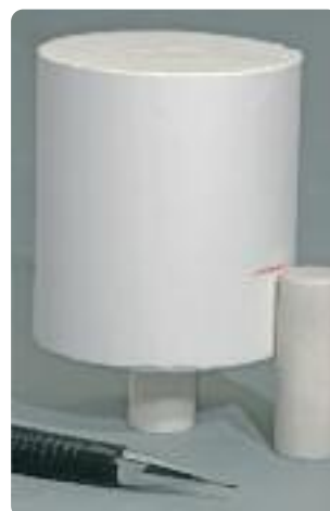
Отметьте длину стержня из оксида алюминия
